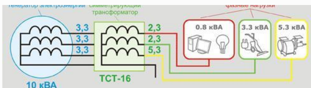
Рис.9 Подключение более мощной нагрузки к тому же источнику электроэнергии с использованием представленной технологии.
